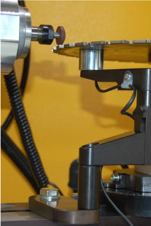
Broušení dutinkového zubu
