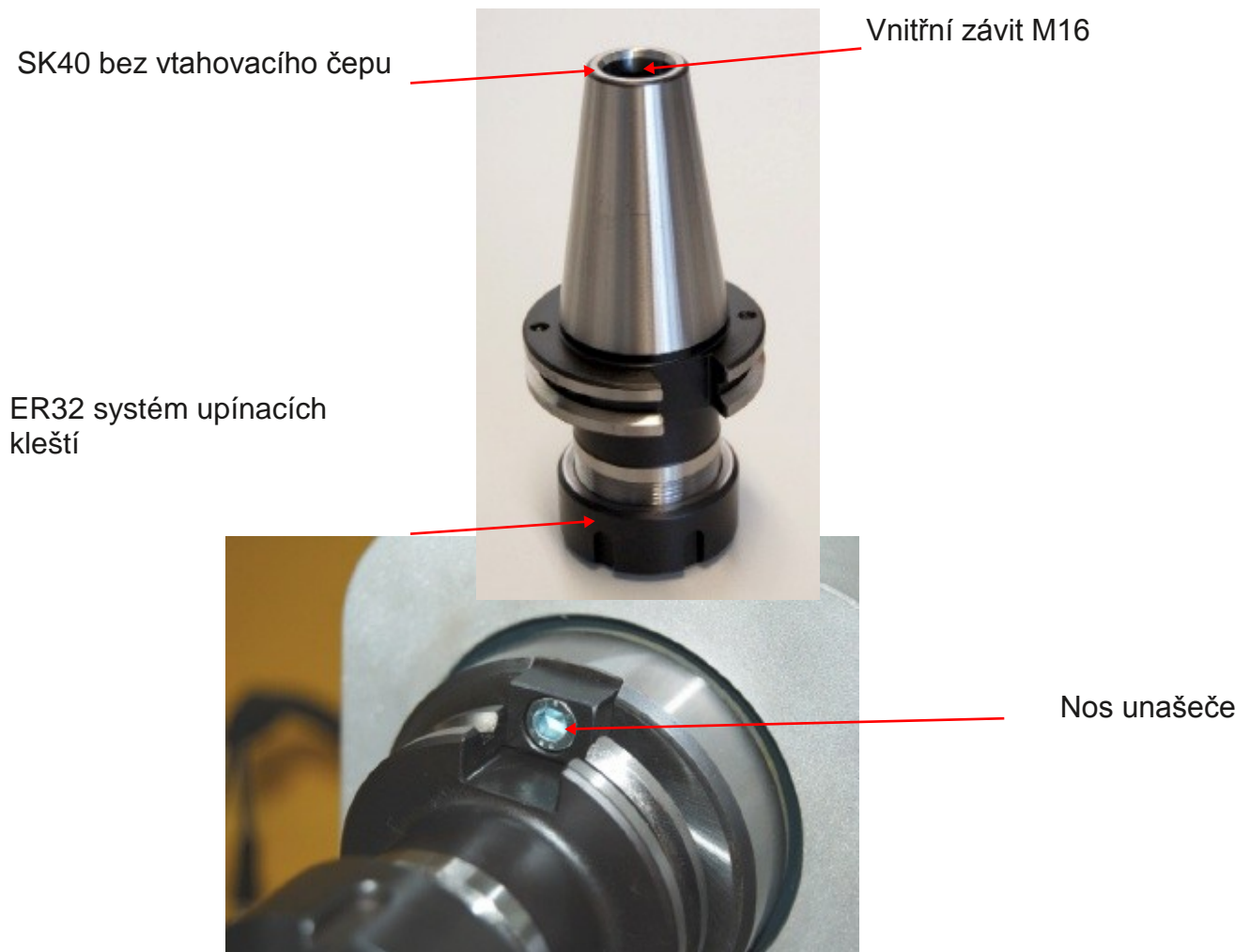
Obrázek 3: Standardní upínač SK40 se systémem upínacích kleští ER32
